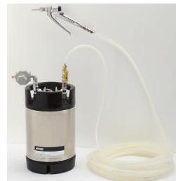
ノズル交換により、ビード塗布・平面塗布・櫛状塗布など多様な塗布に使用できます。
